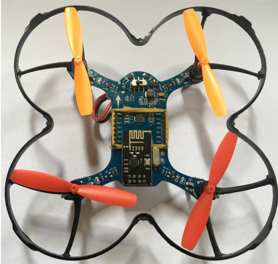
4.打开飞机开关，此时飞机上的4个LED灯开始同时闪烁！
