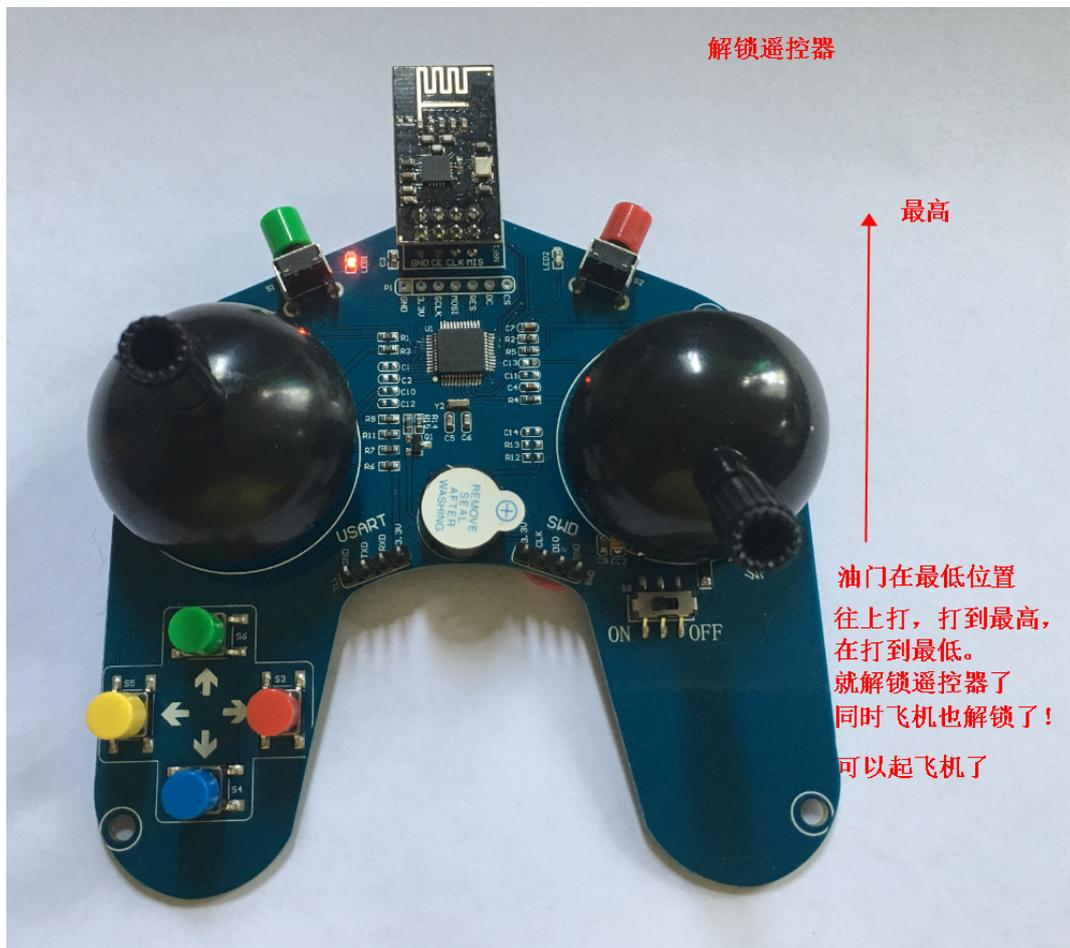
遥控器锁上后，飞机锁上。飞机上的LED灯闪烁亮！
