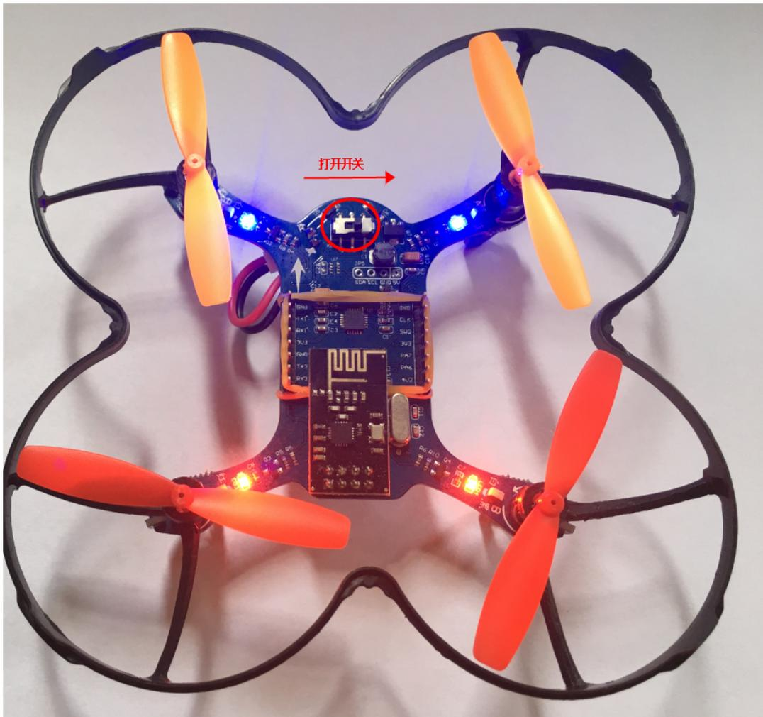
5.分清楚飞机的方向。飞机上面有个白色的箭头，此箭头指示的方向为前，分清楚前后左右，方便你控制飞机。
